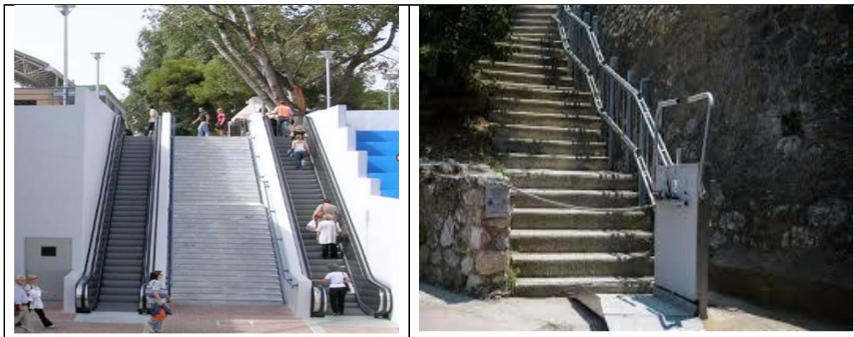
Εικόνα 4-4: Παράδειγμα τοποθέτησης κυλιόμενης κλίμακας (χρειάζεται κυλιόμενος διάδρομος – όχι κλίμακα – για εξυπηρέτηση αμαξιδίων ή αναβατορίου σε υφιστάμενη κλίμακα
